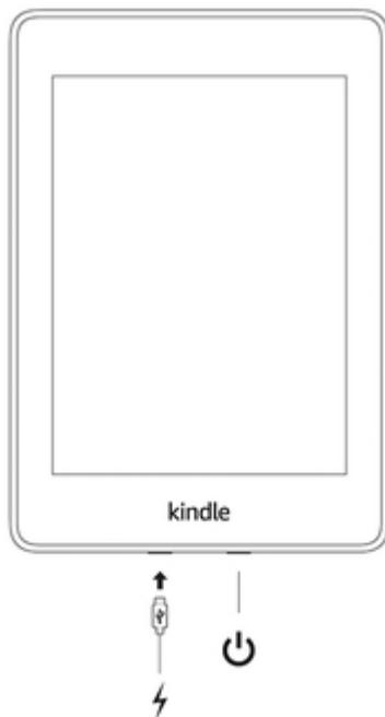
**Vypínač:** Chcete-li Kindle zapnout, stiskněte vypínač, který se nachází na spodním okraji. Chcete-li vypnout obrazovku čtečky Kindle, přidržte vypínač na 9 sekund. Poté se zobrazí dialogové okno možností napájení. Klepněte na Screen Off (Vypnout obrazovku).
