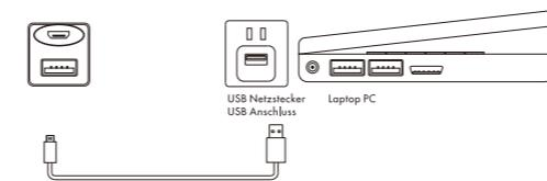
Wir empfehlen, die Powerbank jedes mal vollständig aufzuladen. Nutzen Sie dazu das mico USB zu USB Kabel an Ihrem USB Anschluss/USB Ladegerät.
