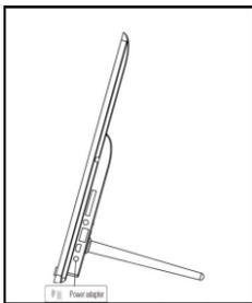
Pripojte dodaný **sieťový diel** k digitálnemu fotorámiku (**DC-IN**). Druhý koniec **sieťového dielu** zapojte do elektrickej **zásuvky**. Digitálny fotorámik sa teraz automaticky zapne. Krátkym stlačením tlačidla **power** vypnete alebo opätovne zapnete digitálny fotorámik.
